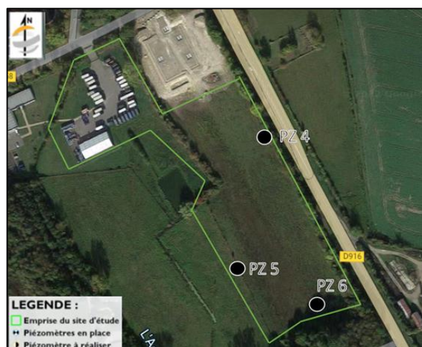
Figure 5 : Localisation des nouveaux piézomètres prévus sur l'emprise VSJ2
